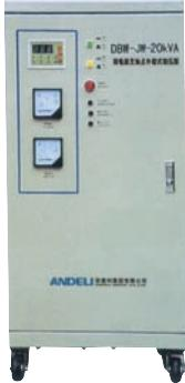
本系列全自动补偿式电力稳压器分为单相(DBW型)、三相(SBW型)二种，与其它形式稳压器相比具有容量大、效率高、无波形畸变、电压调节平稳，适用负载广泛，能承受瞬时超载，可长期连续工作，手控自控随意切换，设有过压、短路、相序保护功能等，使用安装方便，运行可靠等特点。可广泛应用于工业、农业、交通、邮电、军事、铁路、科研文化等领域的大型机电设备、金属加工设备、生产流水线，建筑工程设备、电梯、医疗器械、微机机房、电脑控制设备、刺绣轻纺设备、空调、广播电视、宾馆及家用电器照明等需要稳压的场所。
